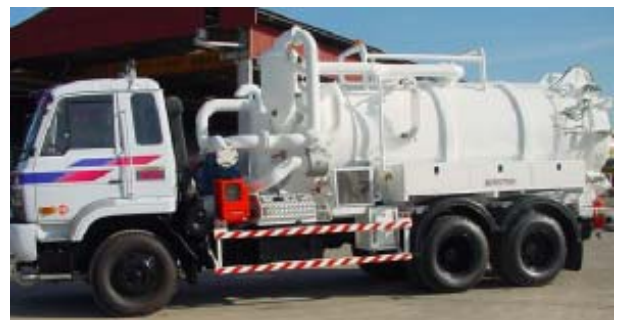
(ซ) แท็งก์บรรจุของเสียที่ทำงานภายใต้สุญญากาศ
