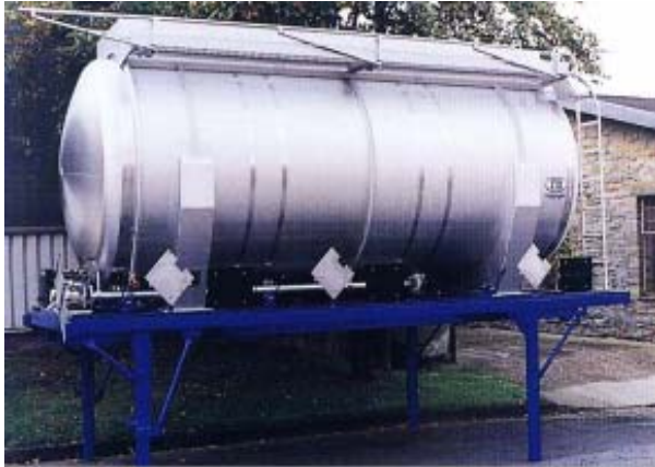
(ค) แท็งก์ติดตึงไม่ถาวรกับตัวรถ (Demountable Tanks)
