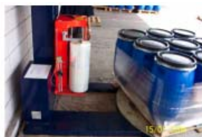
รูปภาพที่ 2-8 แสดงตัวอย่างการผูกยึดภาชนะบรรจุเพื่อป้องกันการกระแทกกัน
