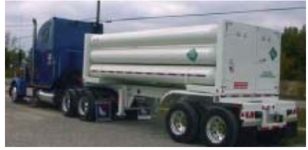
(ข) รถติดตั้งภาชนะบรรจุก๊าซแบบเรียงเป็นดับ (Battery Vehicles)
