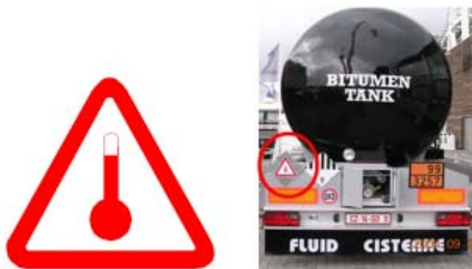
รูปภาพที่ 2-7 แสดงเครื่องหมายสำหรับการขนส่งสารที่มีอุณหภูมิสูง
