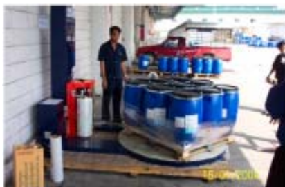
รูปภาพที่ 2-8 แสดงตัวอย่างการผูกยึดภาชนะบรรจุเพื่อป้องกันการกระแทกกัน
