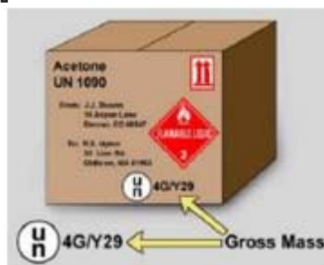
รูปภาพที่ 1-6 แสดงตัวอย่างการระบุมวลรวมสูงสุดหน่วยเป็น กิโลกรัม ของบรรจุภัณฑ์ที่ใช้บรรจุของแข็ง
