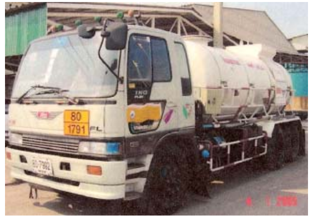
(ฉ) แท็งก์ที่ทำจากพลาสติกเสริมไฟเบอร์ (FRP)
